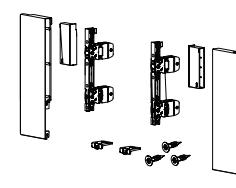
1 Kit para instalação do perfil de alumínio com laterais metálicas
