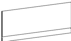
► Perfil frontal em alumínio com 2000 mm para cortar
