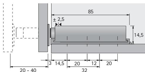
Frente embutida: repor as posições dos furos no correspondente à espessura da porta + 3 mm
